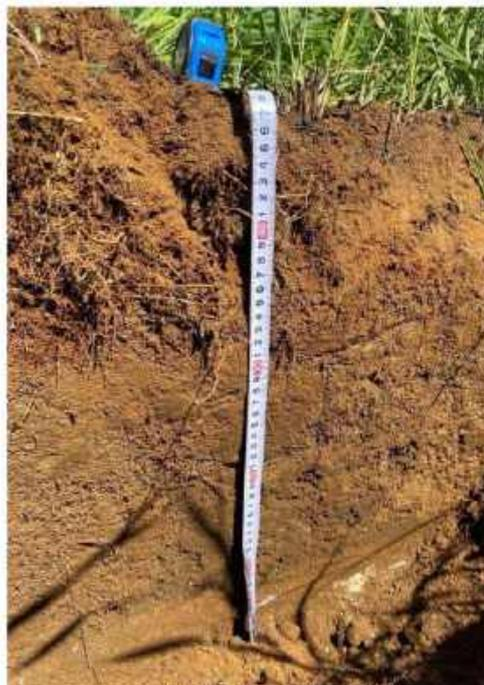
Разрез по копуше №2 - отходы мокрой очистки газов при литье черных и цветных металлов, содержащие преимущественно диоксид кремния, размещены в золошламонакопителе №1 до марта 2016г.
