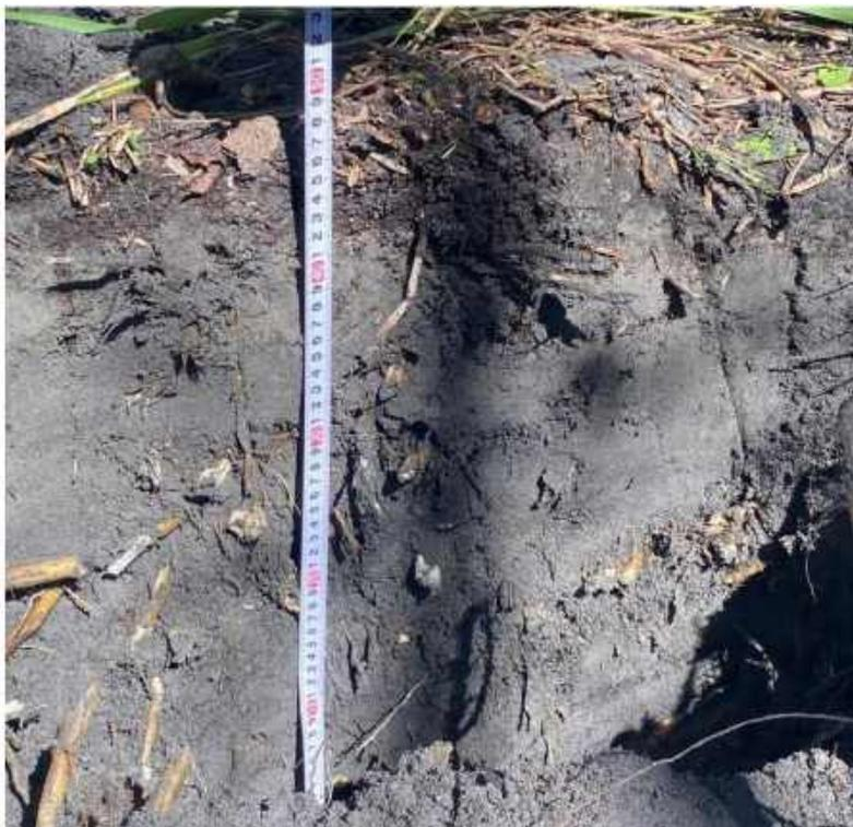
Разрез по копуше №6: отходы мокрой очистки газов при литье черных и цветных металлов, содержащие преимущественно диоксид кремния (код ФККО 35783152325) в золошламонакопителе №2 в районе разделительной дамбы.
